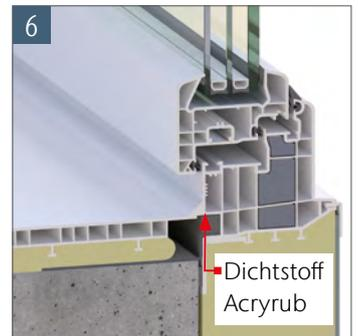
6 Dichten Sie den Übergang von Fensterzarge zum Schalungselement umlaufend mit Acryrub ab
