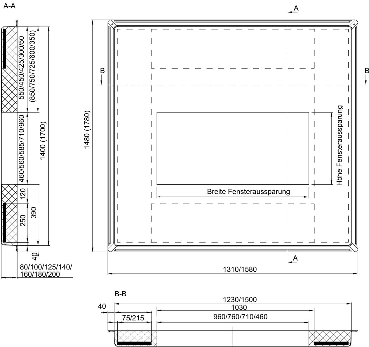
■ Kreisförmige Aussparungen können unter Zuhilfenahme von geeignetem Werkzeug (Bohrkrone für Kunststoffmaterialien) im Therm Block eingebracht werden. Hierzu eignen sich im Besonderen die 1700 mm hohen Montagedämmplatten. Das Einbringen einer eckigen Aussparung als Lüftungsein- oder -auslass für eine Wärmepumpe oder Lüftungsanlage ist nur nach Rücksprache mit der ACO Anwendungstechnik möglich:
